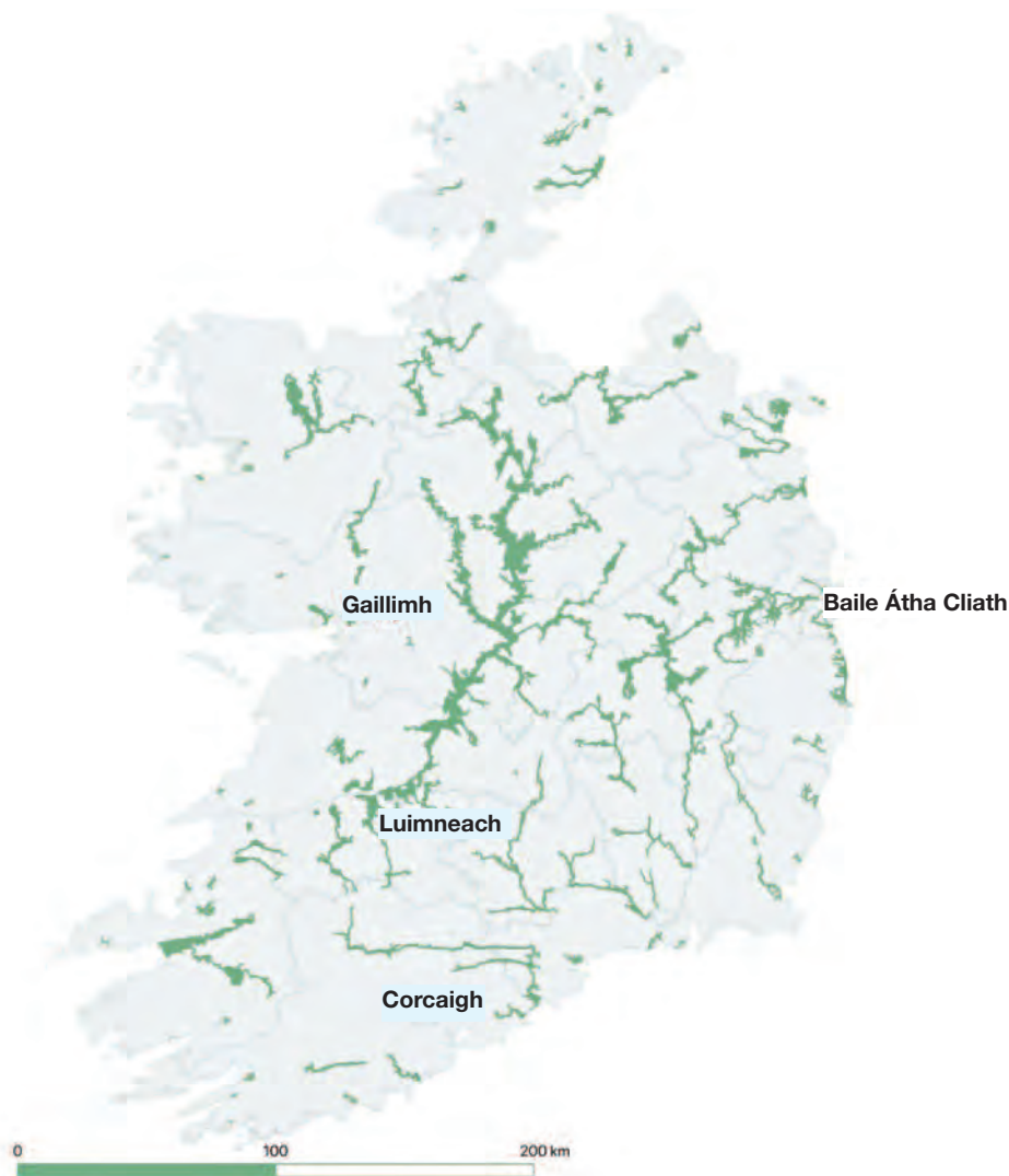
Figiúr 10. Teagmhais tuilte abhann réamh-mheasta (ceantair ghlasa) in Éirinn bunaithe ar chás ard-astaíochta todhchaíoch (méadú 30% ar an titim bháistí agus ardú 1,000mm ar leibhéal na farraige) (OPW, 2018a; An Phríomh-Oifig Staidrimh, 2011)
